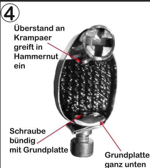
Schieben Sie nun bitte den Krampaer mit Schelle mit der Rückseite (geschlossene Seite) des Krampaers zuerst auf den Hammerkopf. Dabei sollte der andere Überstand am Krampaer in die Nut des Hammers eingreifen.
