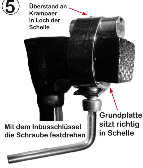
Nun lässt sich der Krampaer-Satz mit der Schraube nach dem Aufschieben festklemmen, indem Sie die Schraube handfest anziehen und somit die Schelle spannen.
