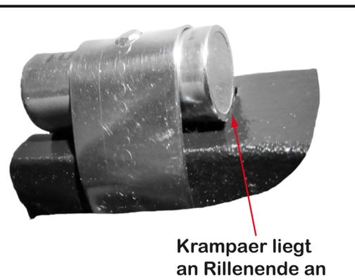
Es ist wichtig, dass das Ende des Krampaers nach dem Aufschieben am Ende der Nut auf dem Hammer anliegt.
